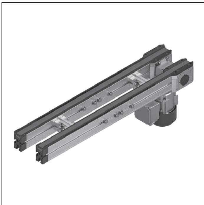
La section à bande est une section de transport prête à fonctionner avec entraînement propre pour le transport de palettes porte-pièces dans le sens longitudinal ou pour le transport transversal de la palette porte-pièces entre des sections de transport parallèles en lien avec deux unités de levée transversale HQ 2.
