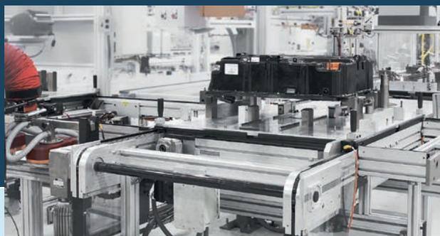
TS 2plus comprend des unités modulaires standardisées faciles à combiner pour former un système. Cela permet la construction de nombreuses variantes pour des installations sur mesure adaptées aux besoins respectifs. Le montage modulaire permet une utilisation rentable de potentiels de rapport en production. Tous les composants sont particulièrement robustes et réutilisables lors du montage des futures générations de produits.
