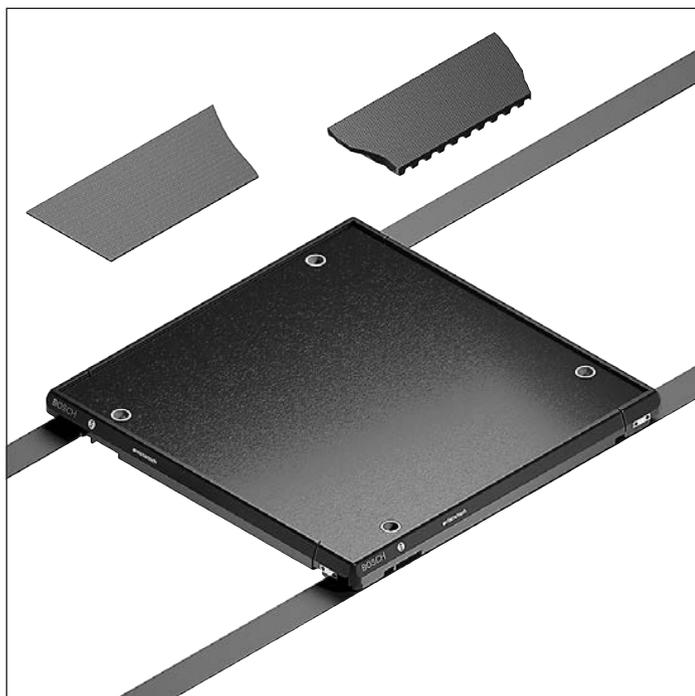
Les convoyeurs courroie et courroie dentée sont appropriés pour le convoyage de palettes porte-pièces de taille réduite et moyenne dans un environnement pauvre en salissures et sec. La grande flexibilité et l'exécution plate du convoyeur permettent des fossés de convoyage étroits entre les segments des sections ainsi que des faibles hauteurs de construction des profilés de section.
