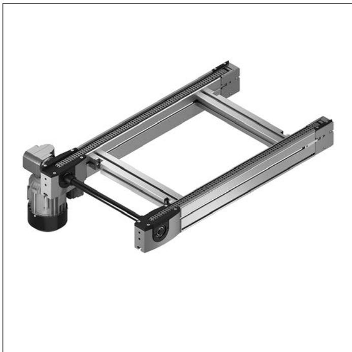
La section à bande est une section de transport prête à fonctionner avec entraînement propre pour le transport transversal de la palette porte-pièces entre des sections de transport parallèles en combinaison avec deux unités de levée transversales HQ 2/... ou pour le transport longitudinal sur des sections de transport jusqu'à 2000 mm.
