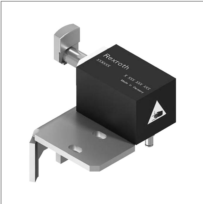
Les amortisseurs DA 2/... sont utilisés pour amortir l'impact de la palette porte-pièces qui arrive lorsqu'elle passe d'une section transversale à une section longitudinale et inversement.
